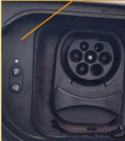
Den Ladezustand des Fahrzeugs erkennen Sie an der LED in der Ladeklappe. Die Farbe hat unterschiedliche Bedeutungen:
