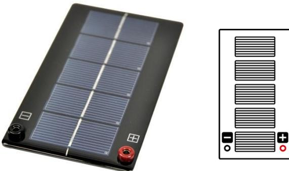
Das Solarmodul ist eine Reihenschaltung aus den 5 Solarzellen.
