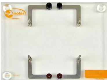
Die Grundeinheit Small ist eine Steckplatine welche bis zu zwei Module aufnehmen kann. Der Strom fließt über die an der Unterseite angebrachten Leitungen. Um die Module auf der Grundeinheit mit anderen zu verbinden, befinden sich an zwei gegenüberliegenden Seiten insgesamt vier Anschlüsse. Für die Verbindung von Modulen auf der Grundeinheit stehen zwei Kurzschlussstecker zur Verfügung.
