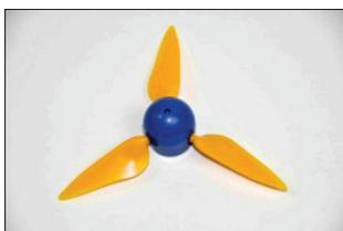
Nach dem Einsetzen der Flügel wird die Nabenkappe aufgesetzt und leicht festgedrückt.
