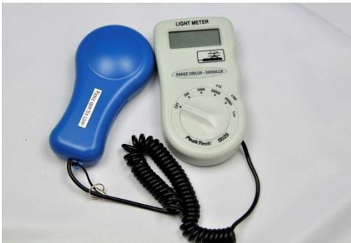
Das Luxmeter misst die Beleuchtungsstärke bzw. den Gesamtlichtstrom pro Flächeneinheit. Es ist als Erweiterung bestellbar und nicht standardmäßig im PV Ready-to-go enthalten.
